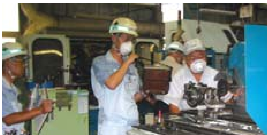
研磨作業に従事する人の周辺で、粉じんを測定。測定器（写真中央の茶色い箱）は作業者の口の位置に掲げて測定する。
